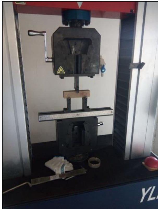
Fig.IV.7 : Essai de FTP sur des éprouvettes lissés en BP.
