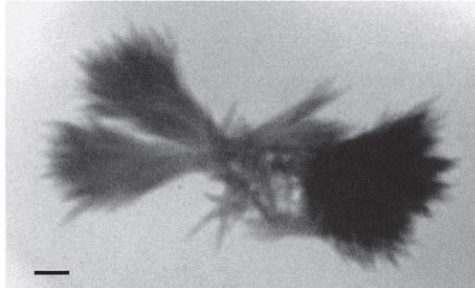
Figure III.5. Images de microscopie à rayons X lors de la réaction du gel de silice dans une solution de NaOH et CaCl 2 [52]. Cette la morphologie est très similaire à la morphologie C-S-H dans la pâte de ciment
