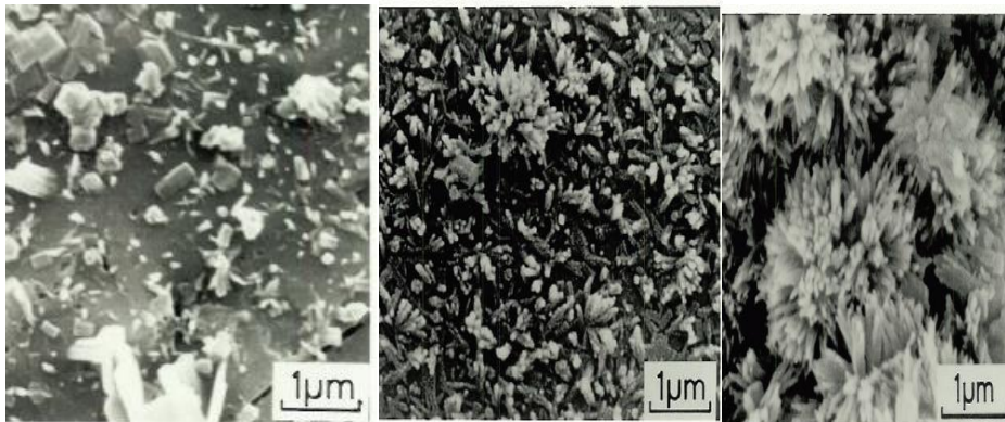
Figure III.4.Ciment hydraté pendant 3 heures, 6 heures et 10 heures de Scrivener [45]
