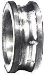
Trous et corrosion
