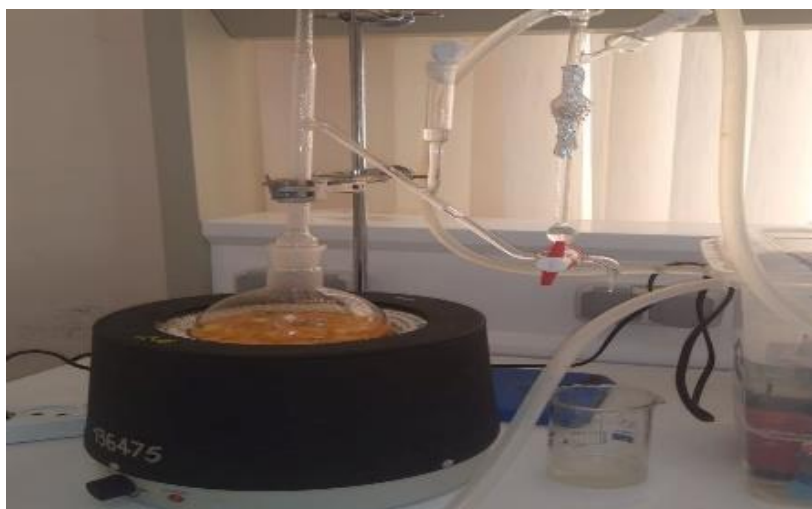
Figure 8: Extraction des Huiles essentielles par Clefenger
