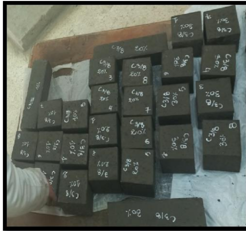
Figure III.10. Etiquetage des différents bétons
