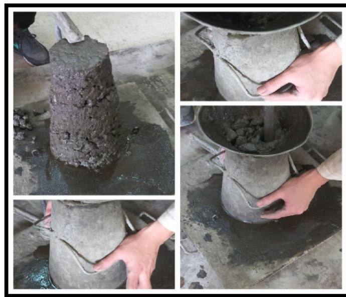
Figure III.11.Essai d'affaissement au cône d'Abrams.
