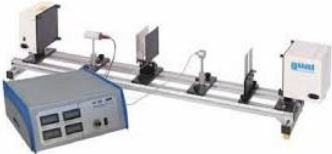
Appareil Transfert de chaleur par mode : Rayonnement
