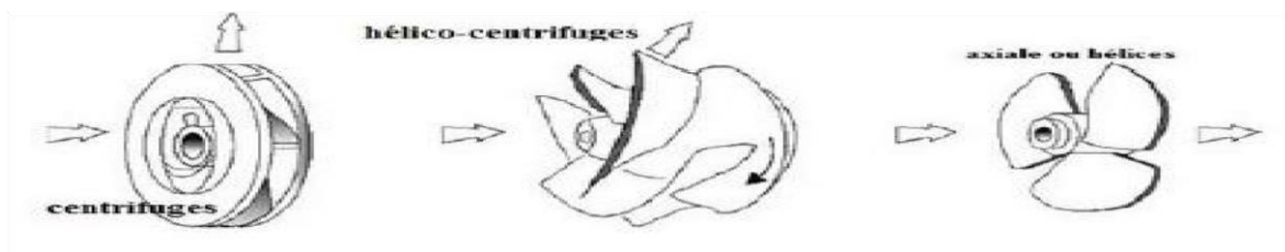
Figure I.22: Représentation des domaines respectifs des trois types de pompes roto-dynamiques. [5]
