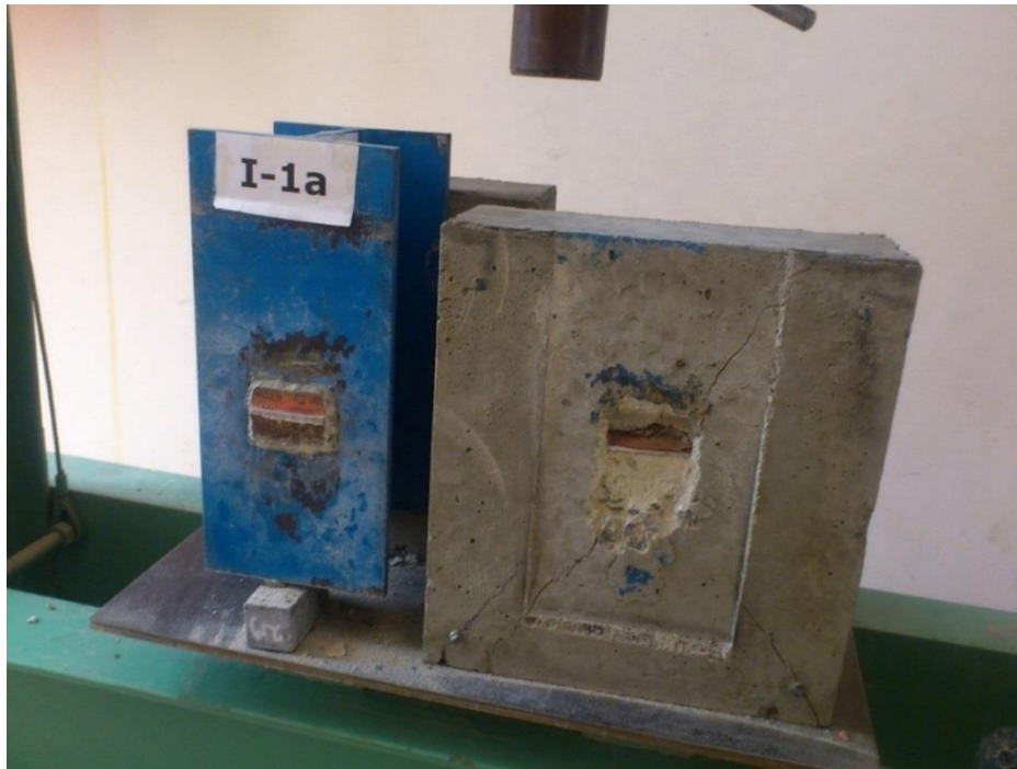
Figure II. 9. Rupture par cisaillement de l'âme du connecteur.
