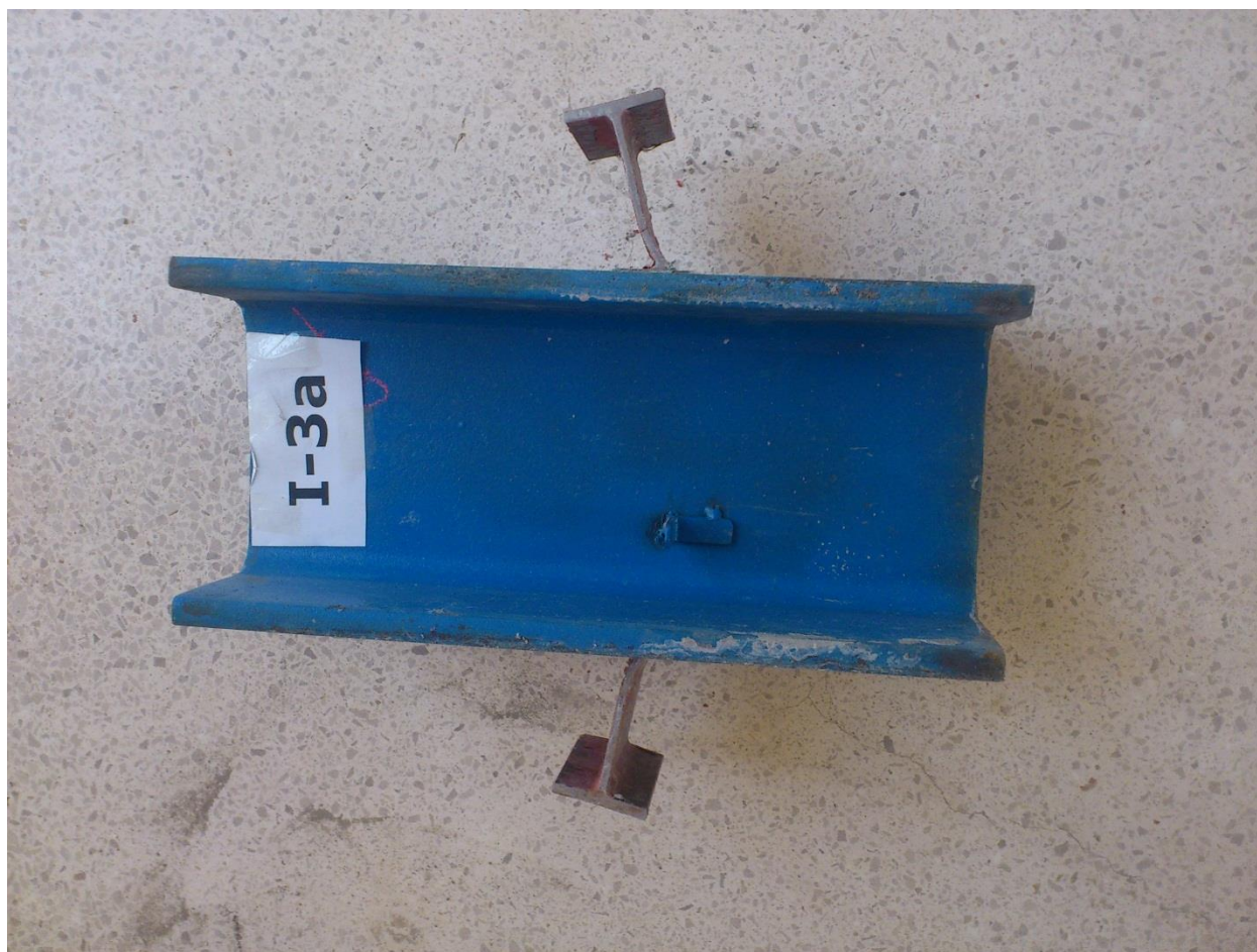
Figure II. 11. Déformation du connecteur en «I».
