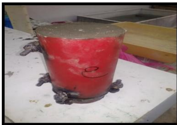
Figure III.17. Mesure de la masse volumique du BCR à l'état frais.
