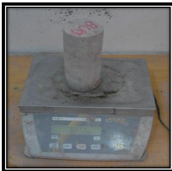
Figure III.18. Mesure de la masse volumique du BCR à l'état durci.
