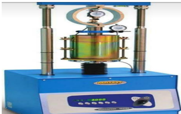
FigureII.10 : - Appareil de poinçonnement (essai CBR).
