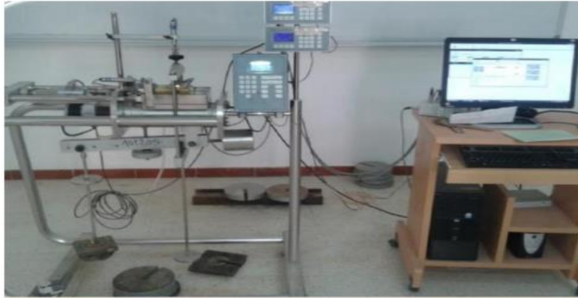
FigureII.12 : -Appareille de cisaillement rectiligne.
