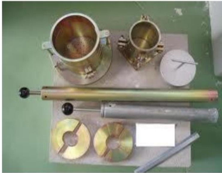
Figure II.8 : Matériel de Proctor (normal et modifié).
