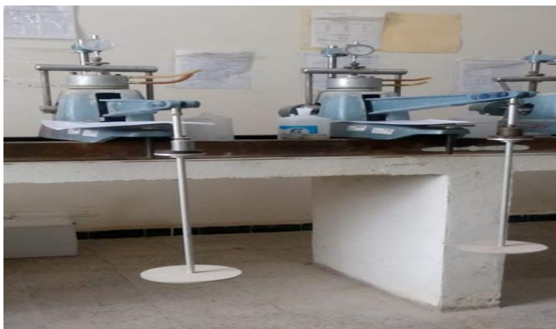
Figure II.16 : - Les machines utilisées pour l'essai œdométrique laboratoire
