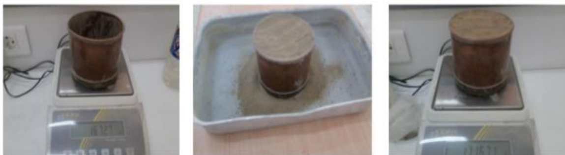
FigureII.2 : Mode opératoire essai masse volumique apparente
