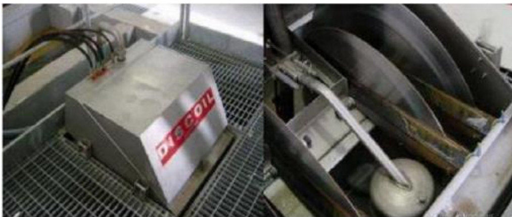
Figure IV-2: déshuileur flottant à disque rotatifs(Discoil) MS-107.
