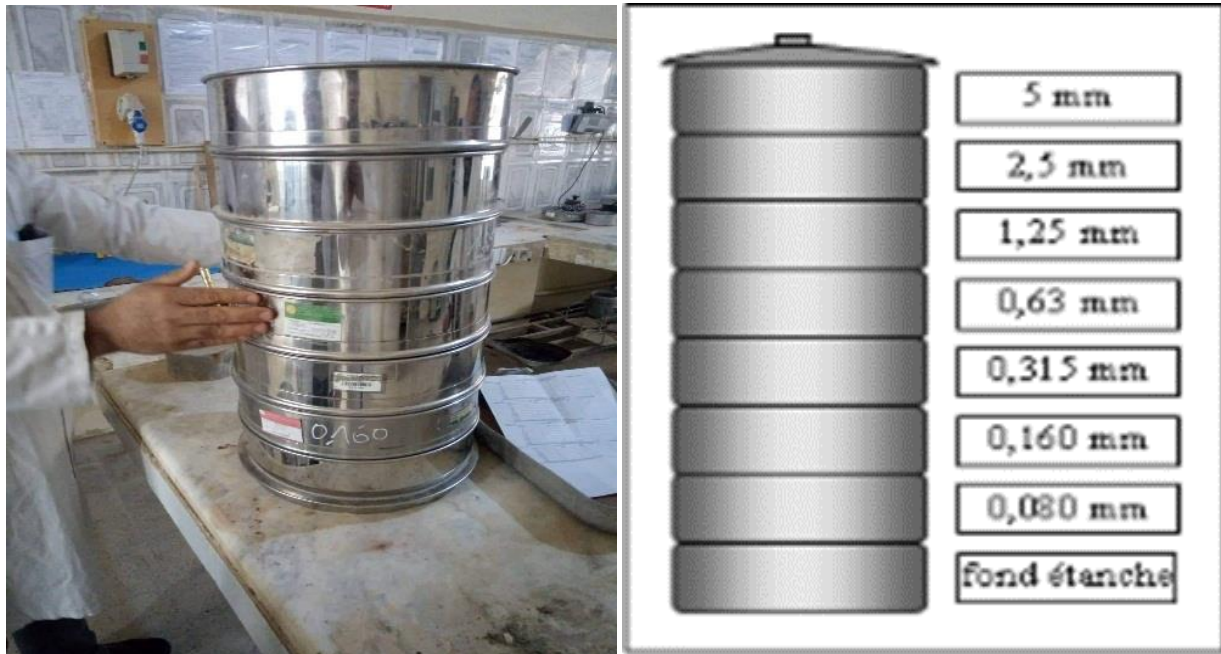
Figure II.2 Appareillage d'analyse granulométrique (tamisage).
