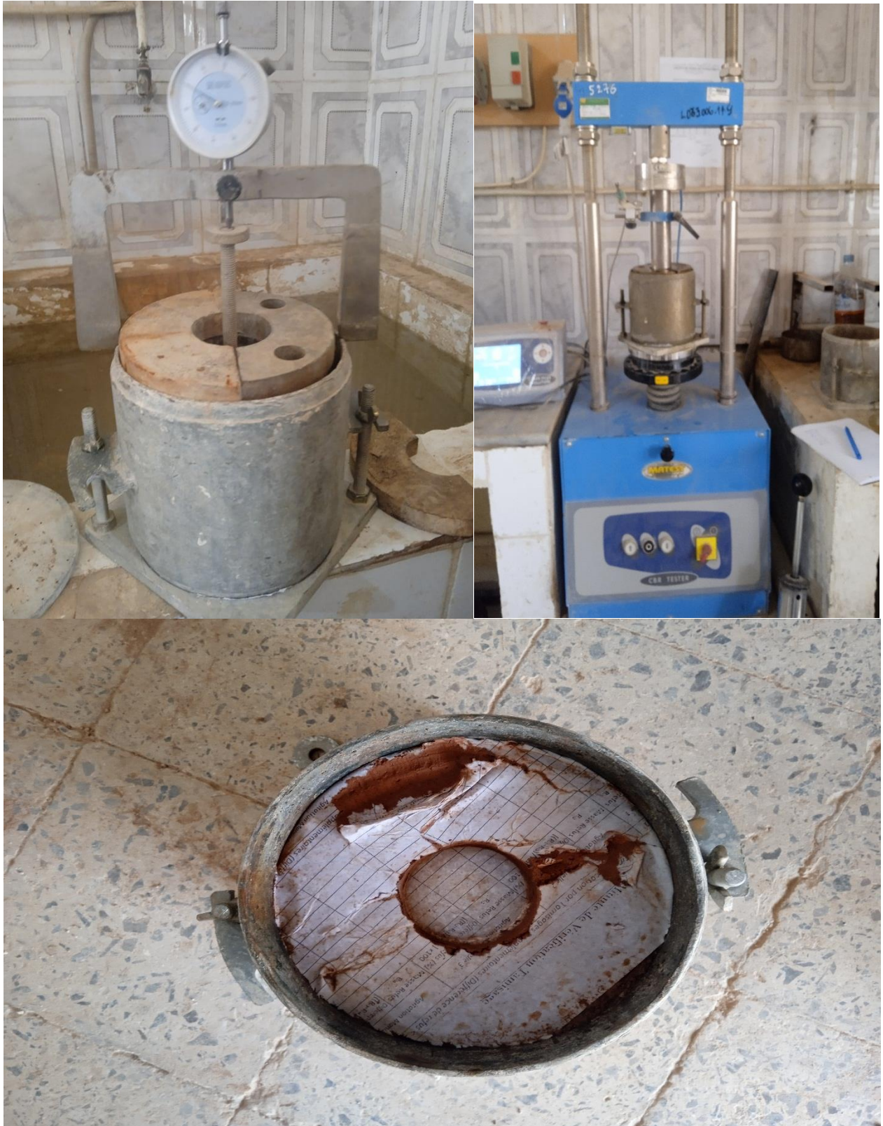
Figure : II.11 Appareil de poinçonnement.
