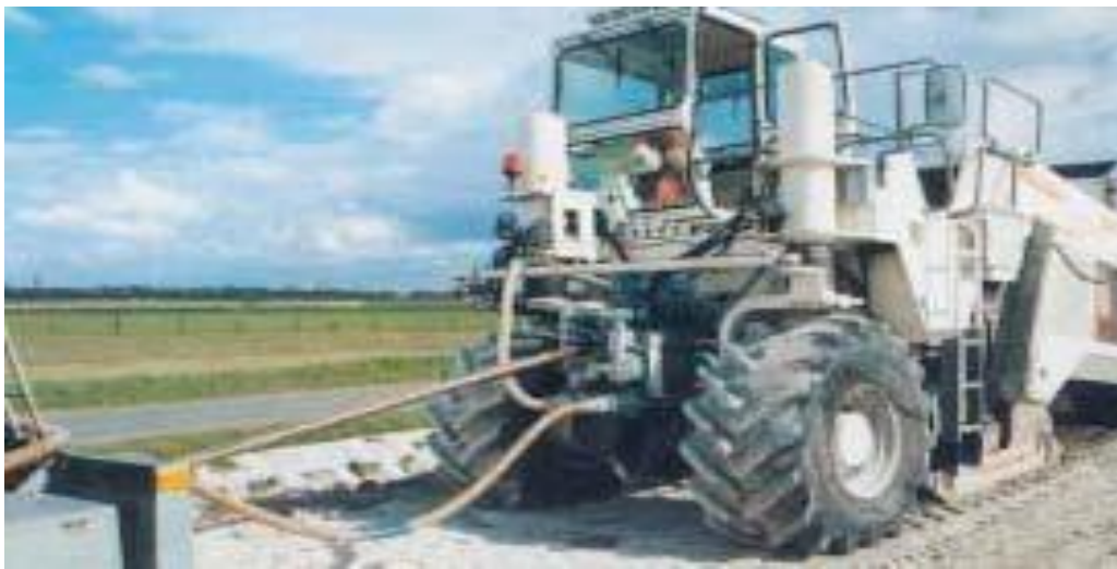
Figure I.11 : Appareil d'incorporation du ciment
