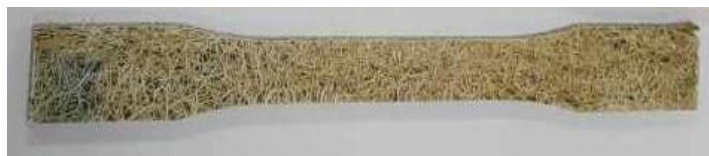
Fig.II.9 : Epreuve après l'usinage.
