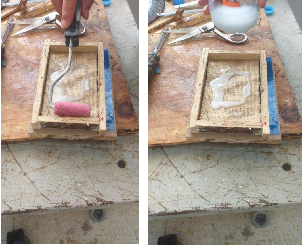
Figure III-5. Empilement de couches
