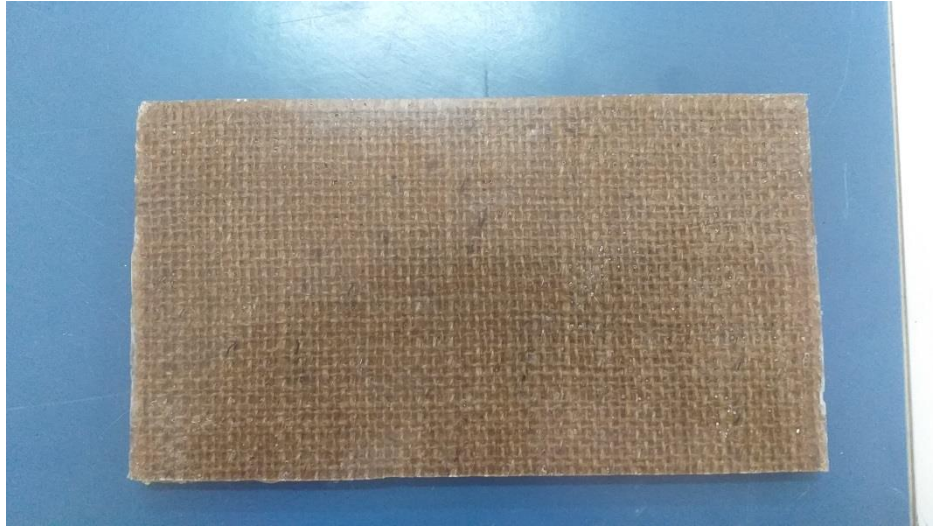
Figure III-7. Plaque composite de référence (0 % alumine)
