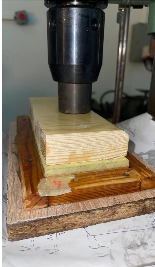
Figure III-6: Étape de pressage sur une presse hydraulique
