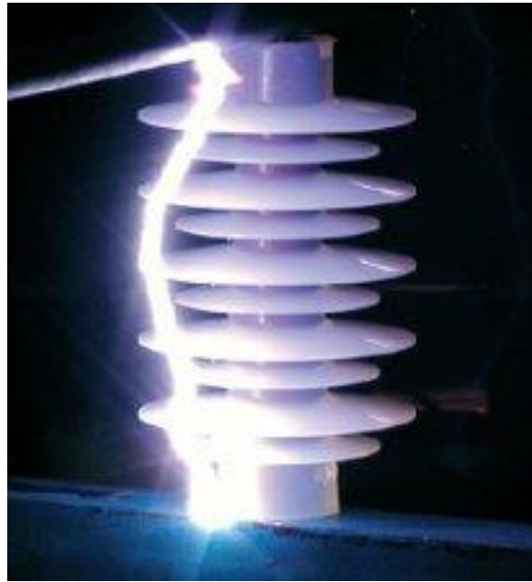
Figure 2. 6. Contournement d'un isolateur
