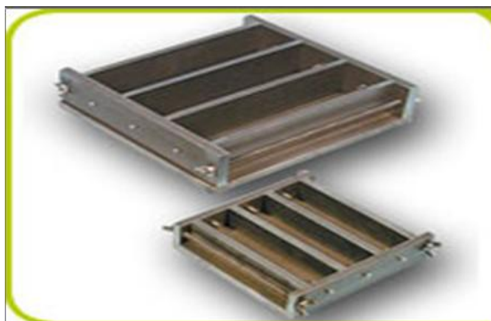
Figure 3-46 Moules ( 4x4x16) cm 3 Équipés de plots de Retrait
