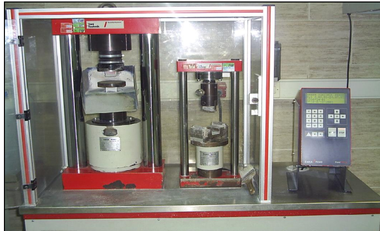
Figure 3-45 Machine de Compression (Laboratoire de Lafargeholcim M'sila )
