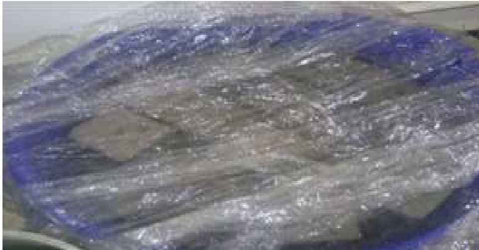
Figure 5.5 Eprouvettes prismatiques (40x40x160) mm 3 immergées dans la solution d'acide sulfurique
