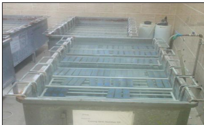
Figure 3-44 Bains d'eau ( laboratoire de Lafargeholcim M'sila )
