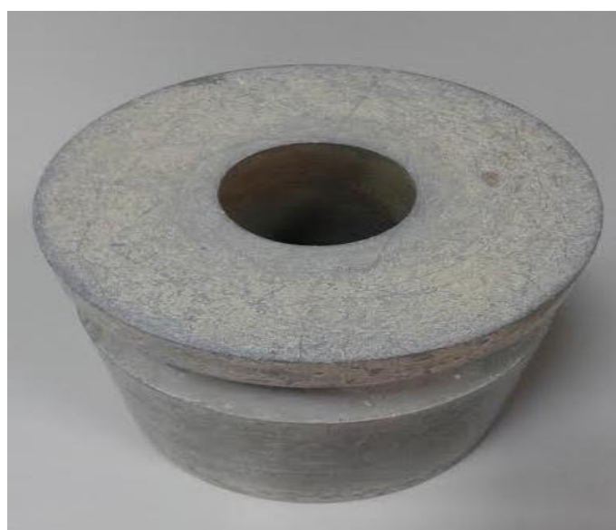
Figure 3-53 Equipement pour mesuré la rhéologie des Ciments MBE ( écoulement et étalement )
