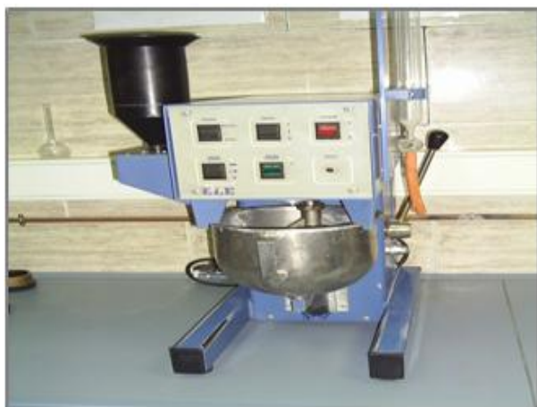
Figure 3-39 Malaxeur semi-automatique de mortier (Laboratoire de Lafargeholcim M'sila)
