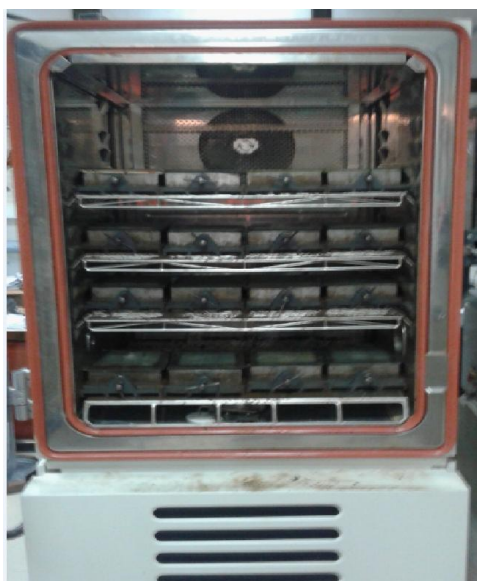
Figure 3-43 La Chambre d'humidité ( Laboratoire de lafargeholcim M'sila )
