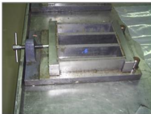
Figure 3-40 Epreuve Prismatique (4x4x16) cm 3 (Laboratoire de Lafargeholcim M'sila)
