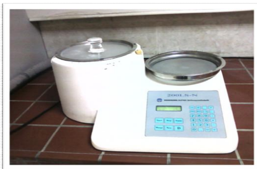
Figure 3-34 Tamiseuse Alpine ( Laboratoire de Lafargeholcim M'sila ).
