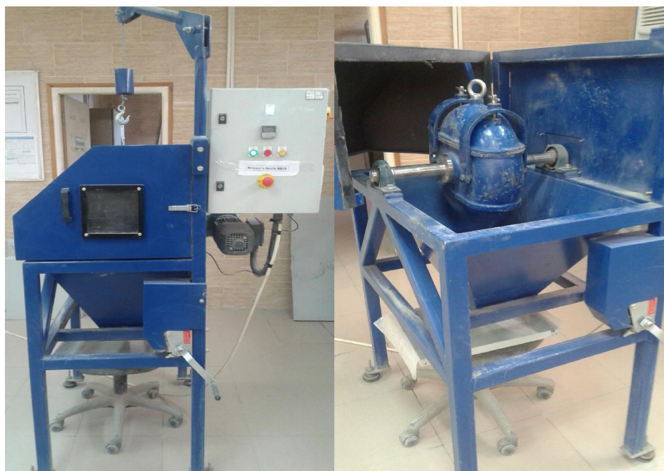
Figure 3-9 Broyeur à boulets BB10 ( Cimenterie Lafargeholcim M'sila )
