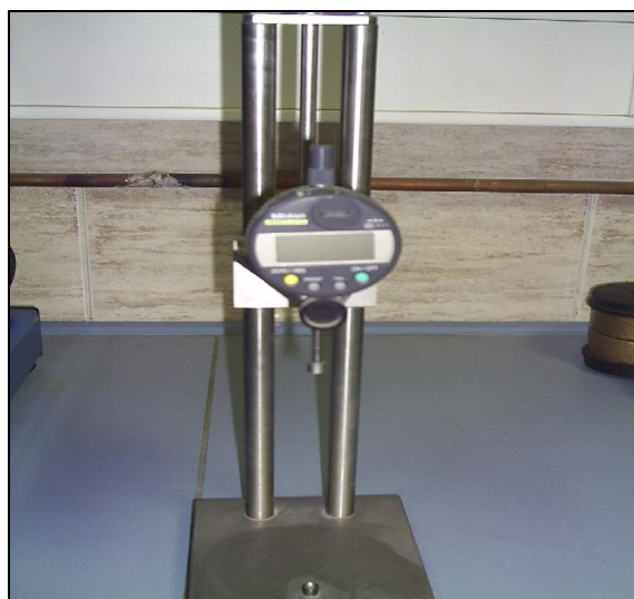
Figure 3-47 Comparateur de Retrait ( Laboratoire de Lafargeholcim M'sila )
