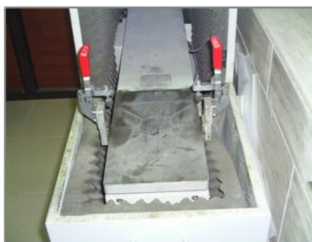
Figure 3-42 Table à Choc (Laboratoire de Lafarge M'sila)
