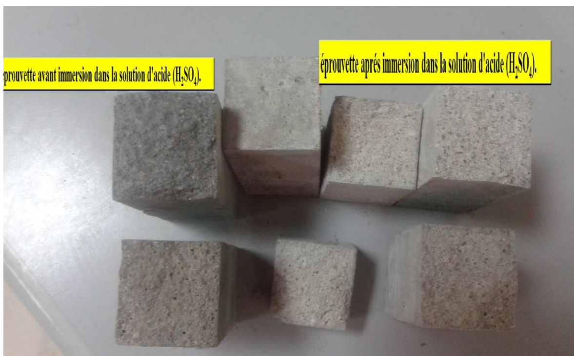
Figure 5.6 éprouvette avant et après immersion dans la solution (acide sulfurique H_2SO_4 )
