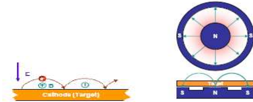
الشكل (I-13) مخططا توضيحيا لمنظومة بالبلازما لترسيب المغناطيسي .
