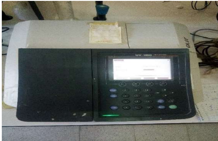
الشكل (I- 26) جهاز التحليل الطيفي ( UV-VIS ) .
