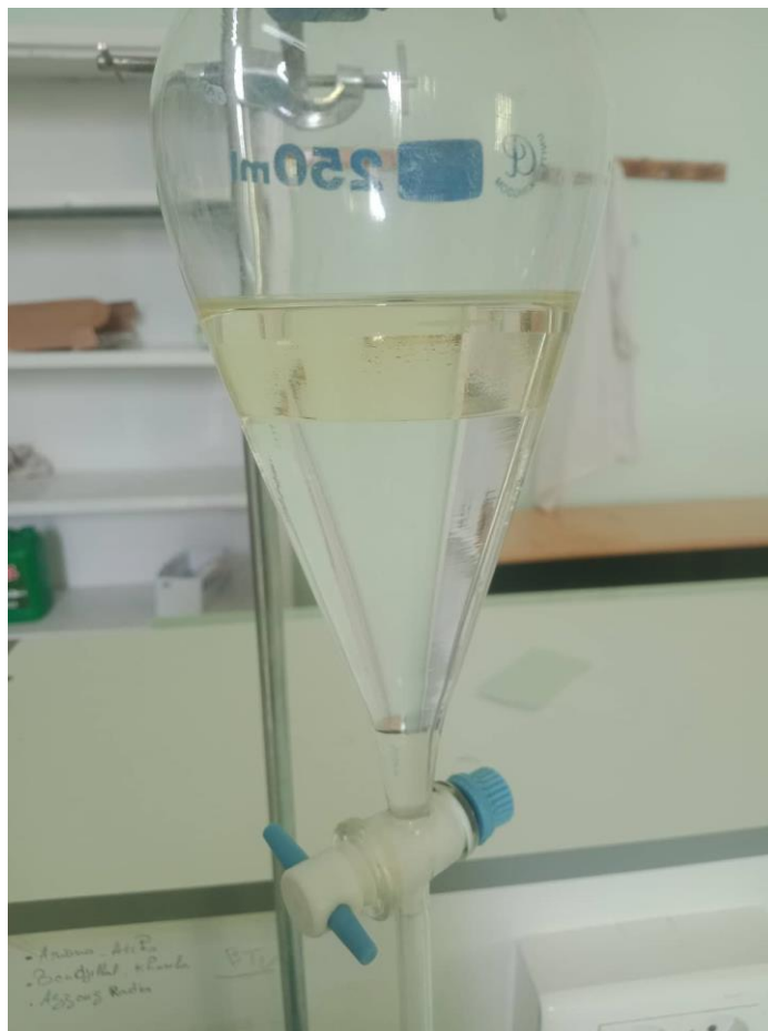
Figure 16 : L'extraction par n – butanol.
