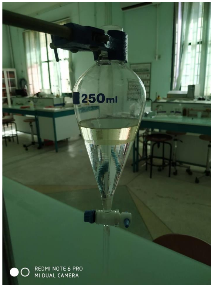
Figure 15 : L'extraction par l'Acétate d'éthyle
