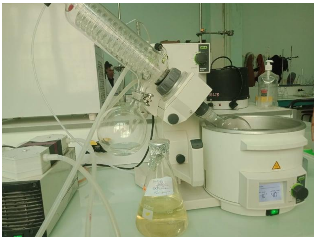
Figure14 : Le rotavapeur (l'évaporateur rotatif).
