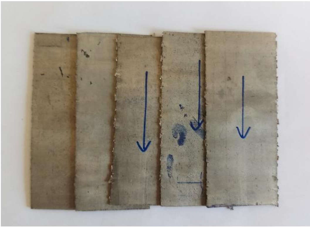
الشكل II-1: سبيكة AZ31 بعد الدرفلة على الساخن وانخفاض سمكها بنسبة 70%.
