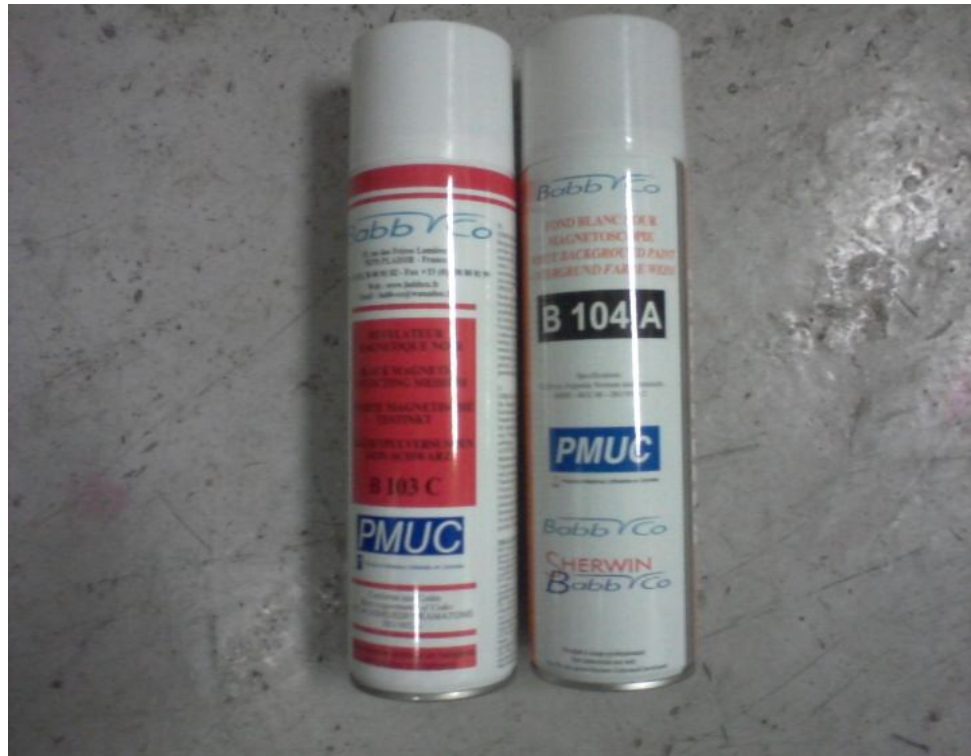
Figure (4. 8): Révélateur pour magnétoscopie et le fond blanc.
