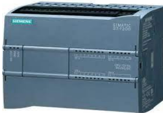
Figure III.10 : photo d'un automate programmable.
