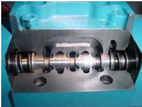
Figure IV-6 : vue à l'intérieur d'un distributeur 4/3 centre ouvert A et B vers T [8]
