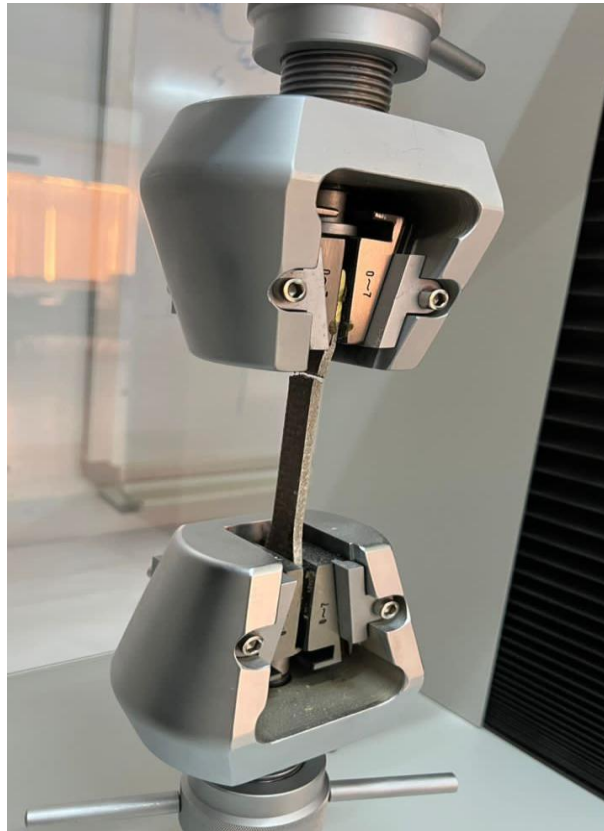
Figure II. 9: Éprouvette fixée entre les deux mors de la machine.
