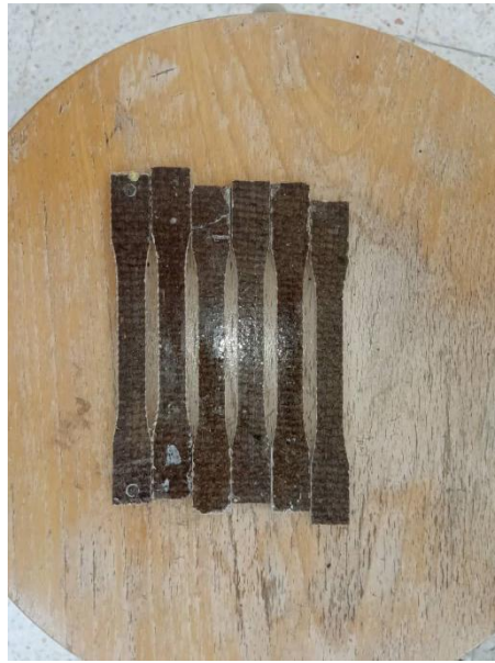
Figure II. 7: Les éprouvettes usinées par machine CNC.
