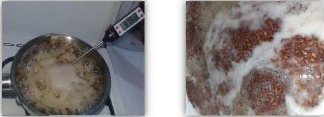
Figure 9. Extraction du gel par ébullition des grains de lin.
