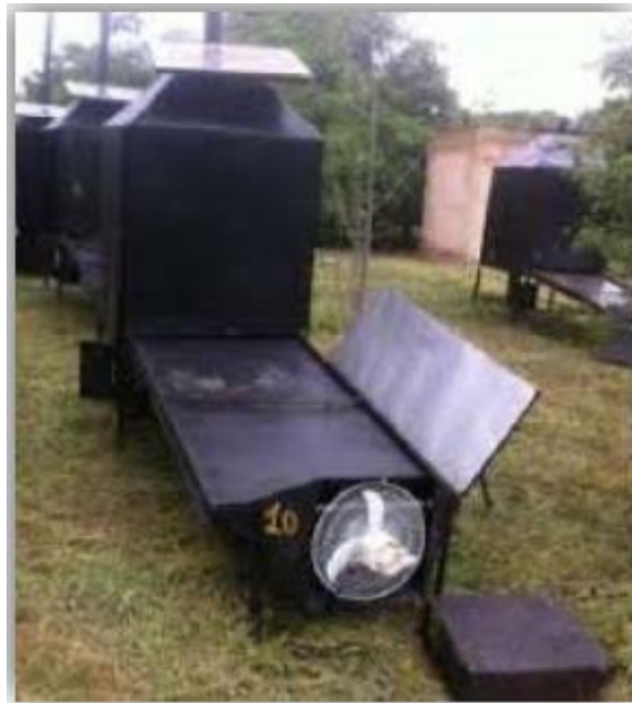
Figure I.23 Séchoir solaire hybride à convection forcée[29]
