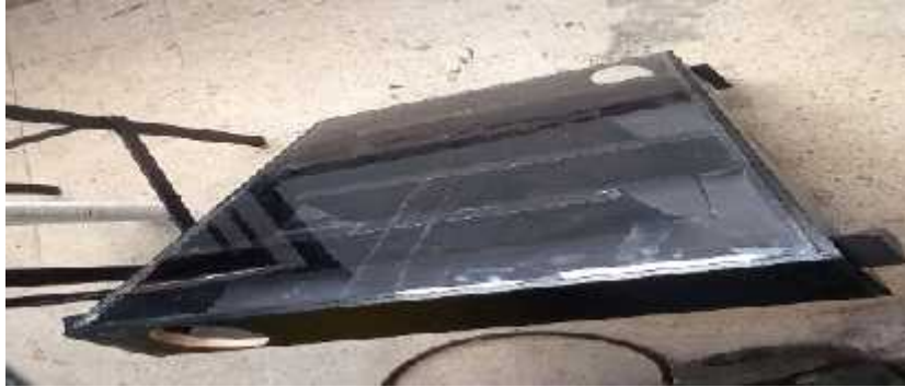
Figure IV.8 Pose du vitrage
