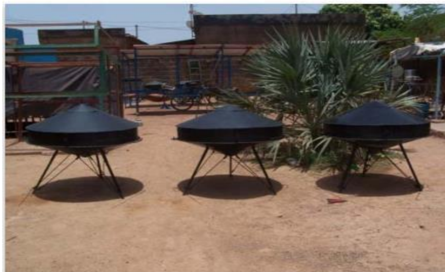
Figure I.16 Le séchoir solaire coquillage à trois claies[26]
