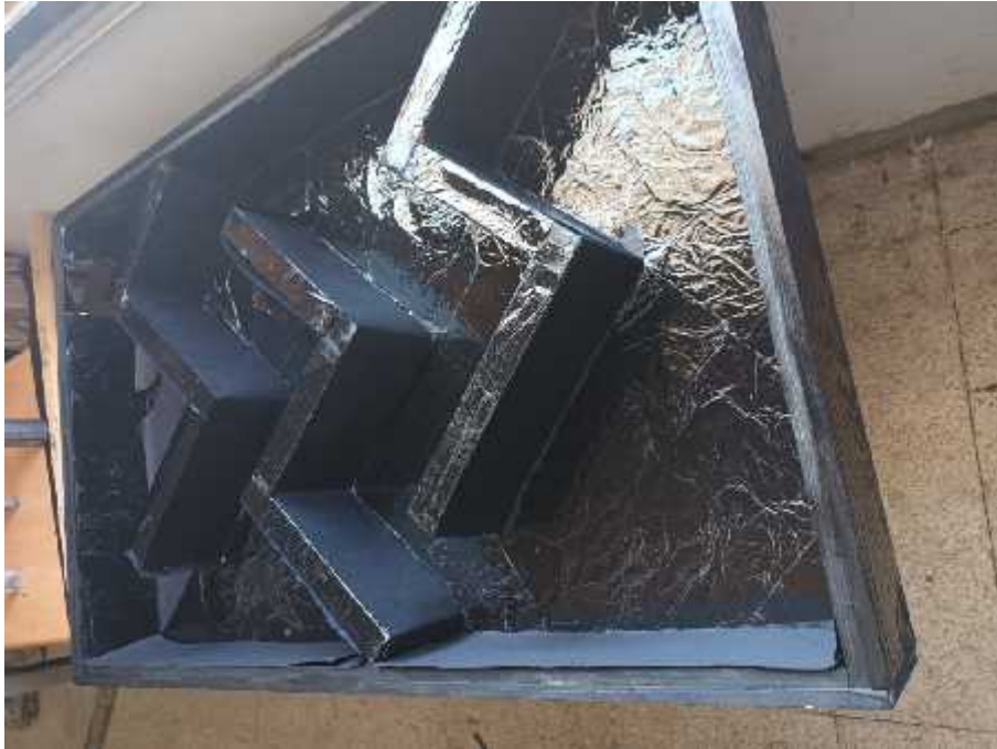
Figure IV.10 Vue du capteur solaire C2(à ailettes intercalées en zigzag)
