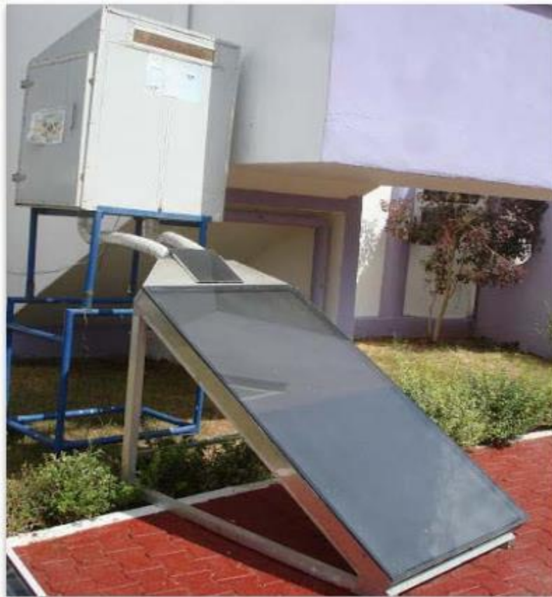
Figure I.21 Séchoir solaire indirect destiné au séchage des PAM [21]
