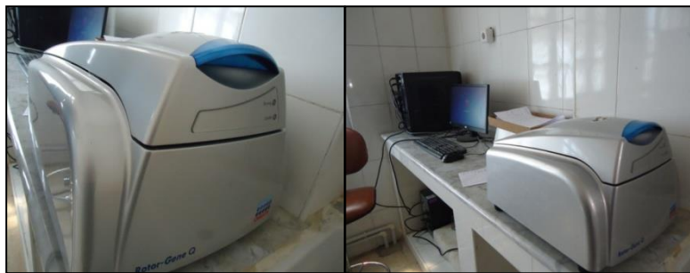
Figure 15. Thermocycleur en temps réel « Rotor gene Q » (IP M'sila)
