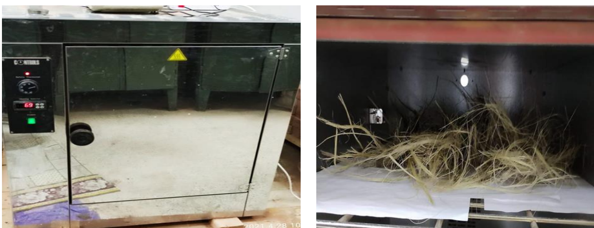
FigureIII.3. Traitement thermique : l'étuvage des fibres d'eucalyptus.
