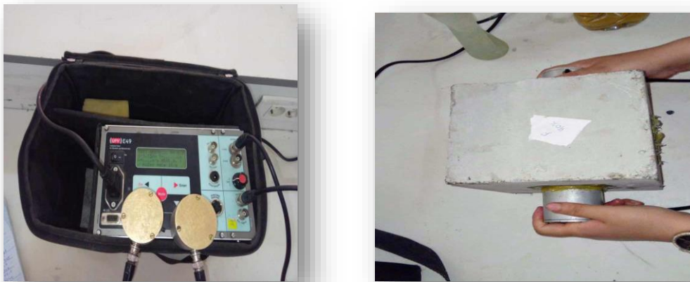
Figure III.19. Mesure de la vitesse ultrasonique.
