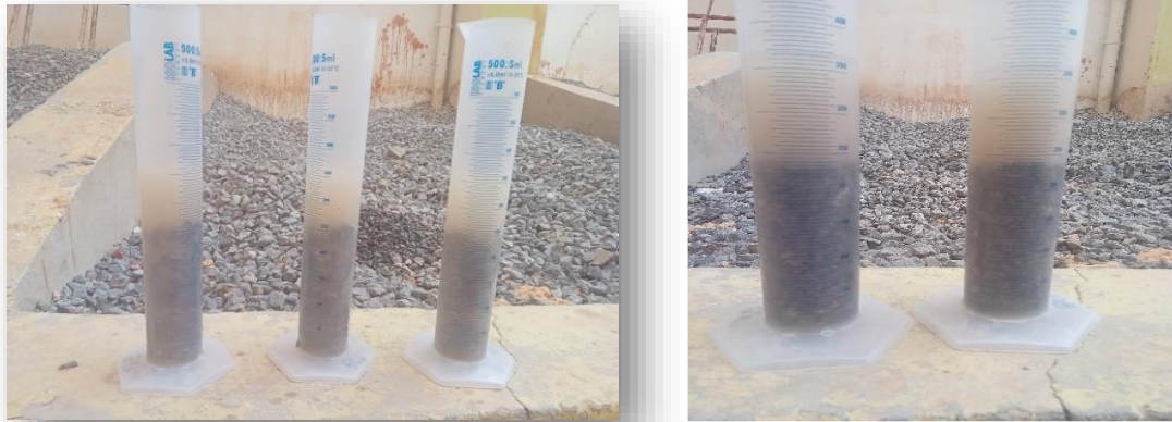
Figure III.4. Essai La masse volumique absolue des graviers (8/16, 3/8) au laboratoire.
