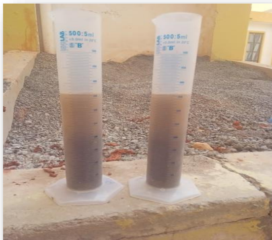
Figure III.3. Essai La masse volumique absolue des sables concassés au laboratoire.
