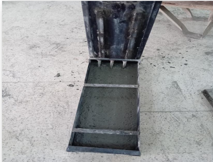
Figure III.16. Essai de boîte en L.
