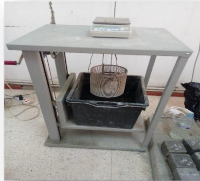
Figure I.21 : Essai de porosité accessible à l'eau
