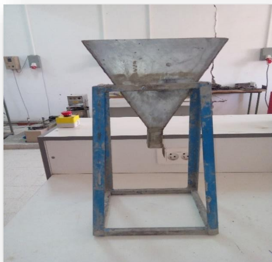
Figure III.13. Dispositif de l'essai V-Funnel.
