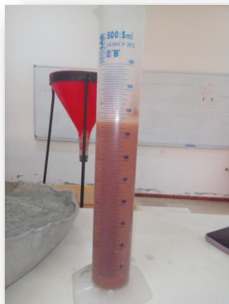
Figure III.5. Essai La masse volumique absolue des briques au laboratoire.
