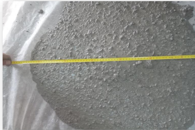
Figure III.14. Essai d'étalement au cône exécuté au laboratoire.
