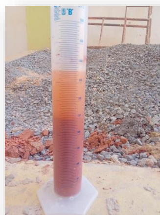
Figure III.5. Essai La masse volumique absolue des briques au laboratoire.
