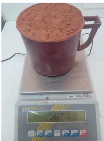
Figure III.7. Essai La masse volumique apparente des briques au laboratoire.
