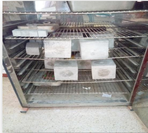
Figure III.22. Séchage des éprouvettes.
