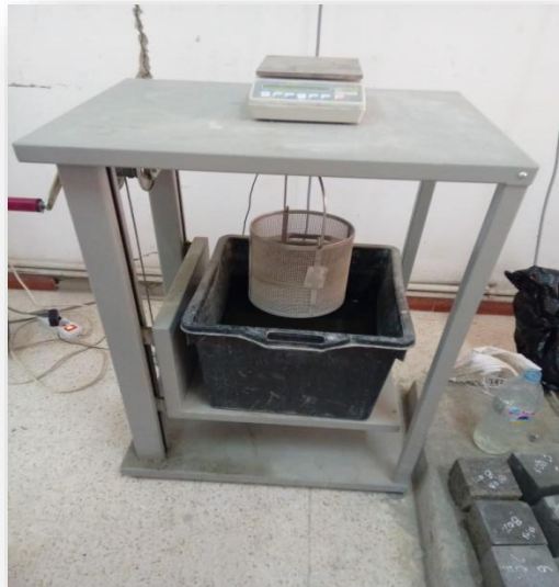
Figure III.20. Mesure de la porosité accessible à l'eau
