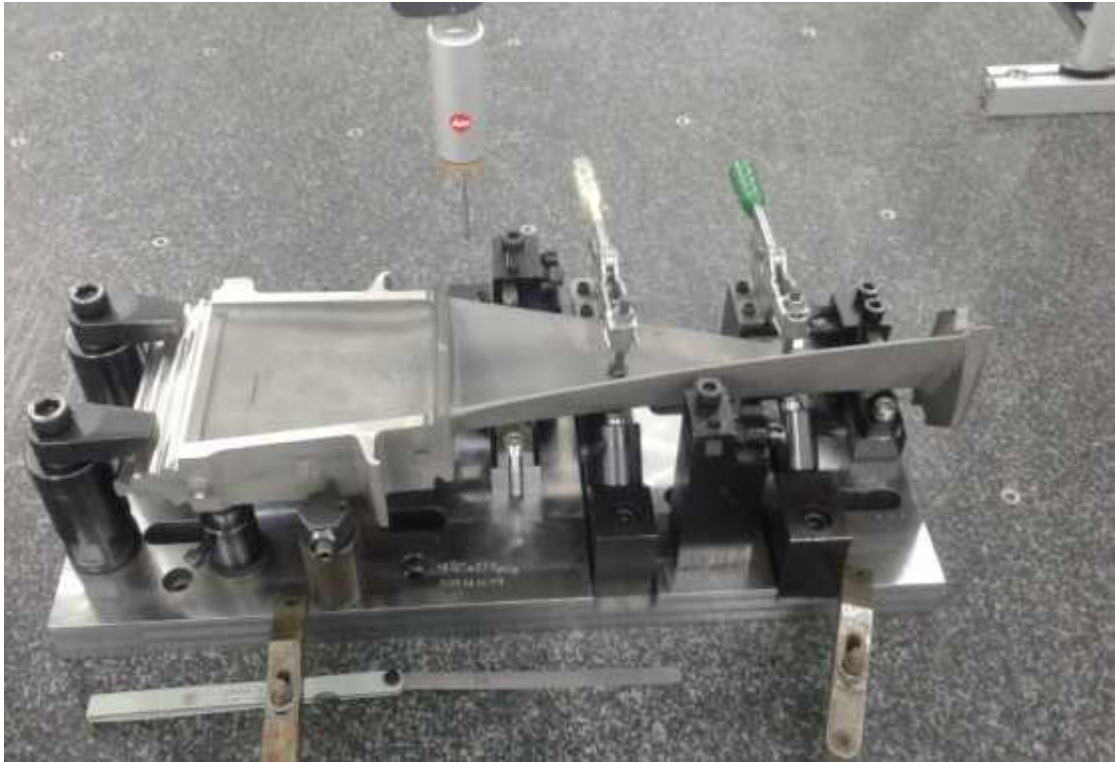
Figure V.2 : Ensemble ailette et MU sur la table de la MMT.
