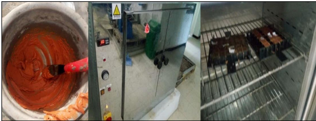
Figure II.20. Confection et durcissement à l'étuve des géopolymères [MEH 22].
