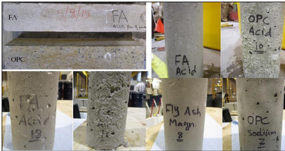
Figure III.7. Effet de l'exposition pendant 9 mois à différents milieux agressifs sur les bétons géopolymères et les bétons de ciment [ALB 17].
