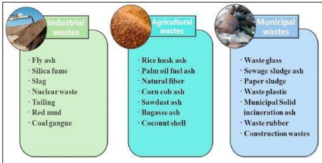
Figure II.1. Catégories des matériaux solides utilisés comme précurseurs pour l'élaboration des géopolymères, selon Ren et al, [REN 21].
