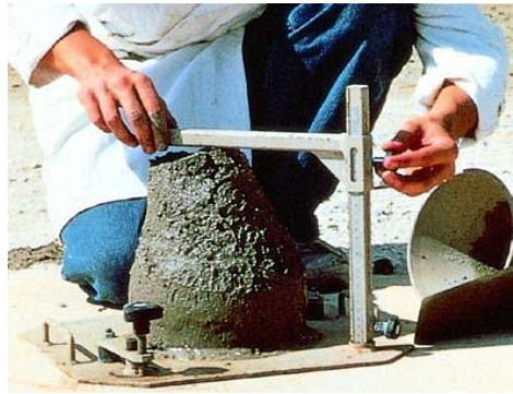
Figure 13 : Mesure de l'affaissement. [29]
