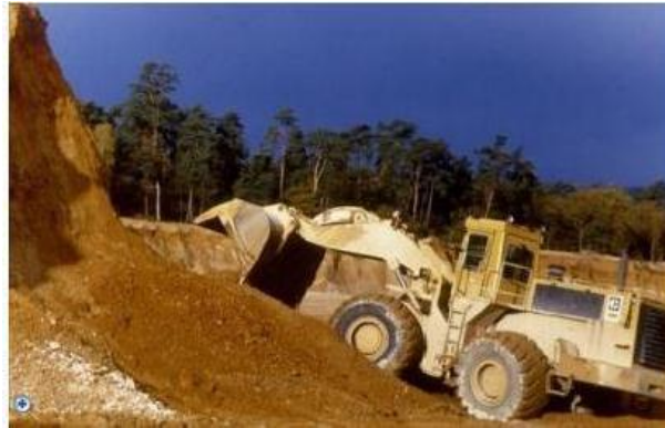
Figure II.3 : Exploitation de granulats alluvionnaire à la chargeuse en terrain sec.
