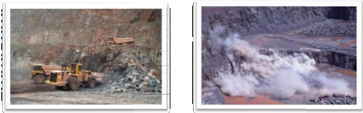
Figure II.5 : Exploitation de granulats alluvionnaire à la chargeuse en terrain sec.
