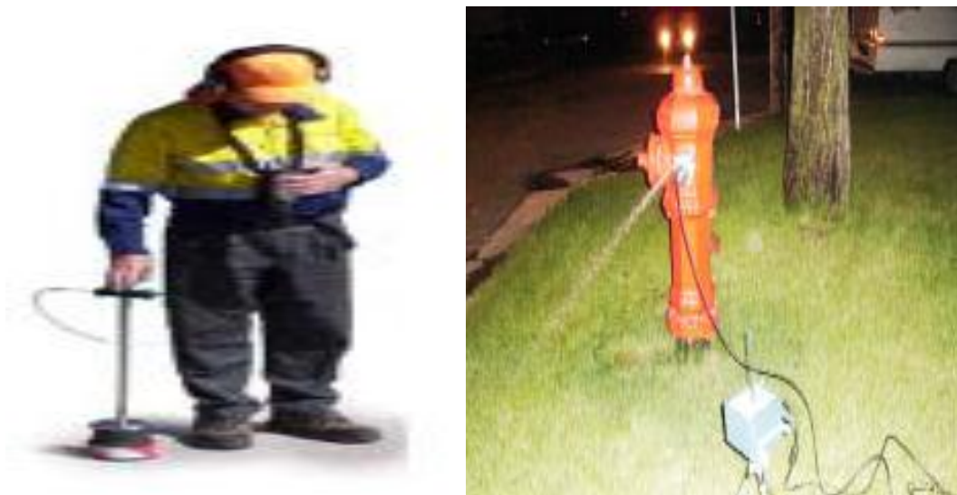
Figure I.8 Appareils d'auscultation typiques
