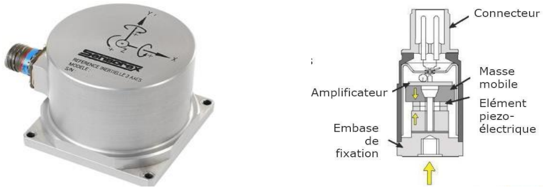
Figure I.3 : Schéma de principe d'un accéléromètre.
