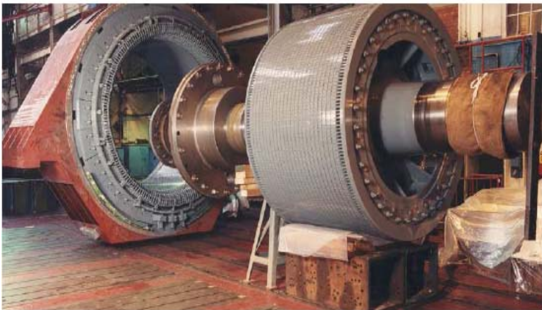
Fig(I.1) : Machine asynchrone de 4,7 MW, 45 tr /min
