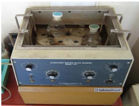
Figure I- 9: Photographie de l'agitateur secoueur utilisé pour l'extraction batch.
