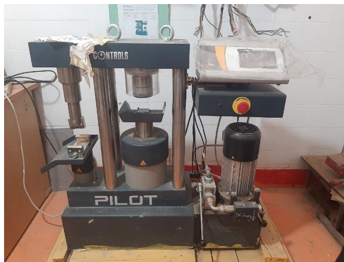
Figure II.12: L'essai de compression et de flexion par traction.
