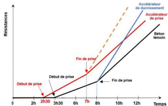
Figure I.7 : Effets d'un accélérateur de prise / de durcissement. [4]
