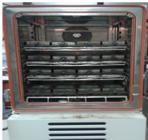
Fig III.4 : La Chambre d'humidité (Laboratoire de lafargeholcim M'sila ).
