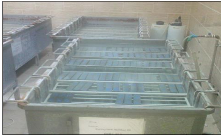
Fig III. 5: Bains d'eau (laboratoire de Lafargeholcim M'sila ).
