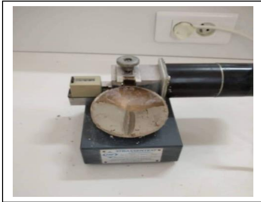
Figure III .9 : Appareil de Casa grande et matériel de la limite de liquidité pour
