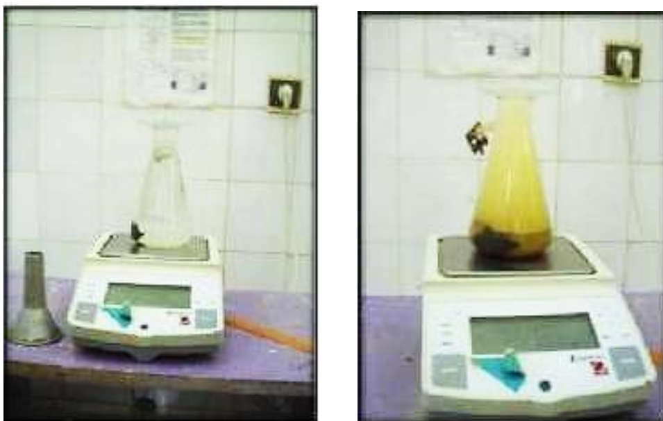
Figure III.6. Essai de la masse volumique absolue.
