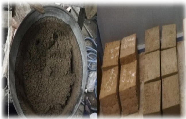
Fig : mélange de sol et blocs coulés
