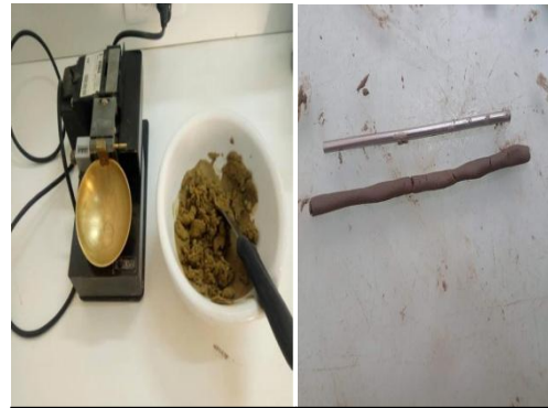
Fig III .6 . Les limites d'Atterberg (NF P94-051)
