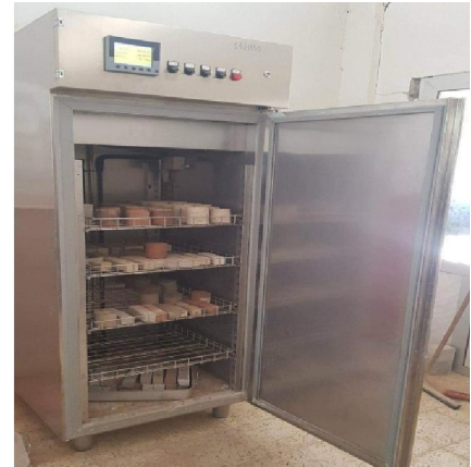
FigIII.10 : chambre de cure (Température ,Humidité) (Laboratoire géo matériaux M'sila)
