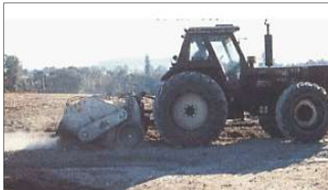
Figure V.36 : Aération (source SETRA).
