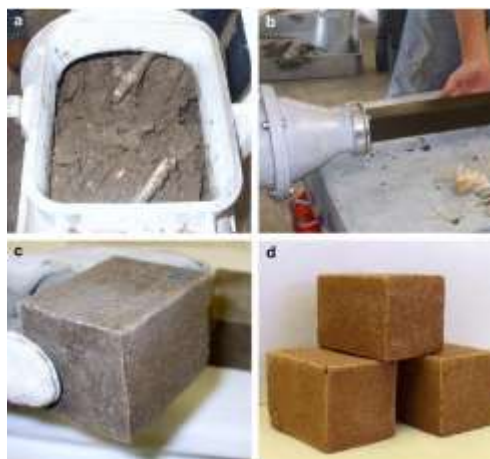
Figure III.25:Brique à base de sédiment de Savannah (Mezencevoca, et al, 2012).
