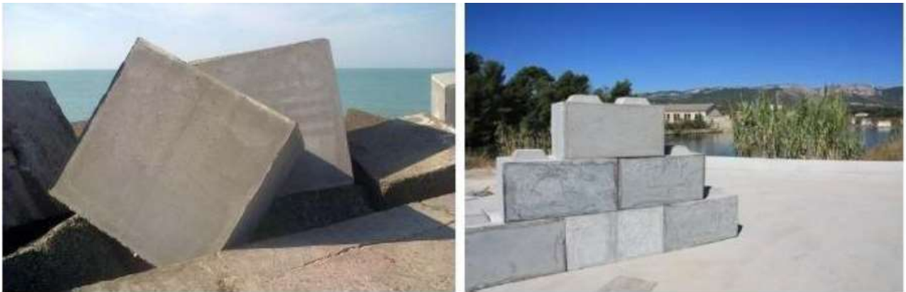
Figure III.21 : Blocs de bétons réalisés avec des sédiments non-immérgeables traités(droite : Port de Dunkerque , gauche : Rade de Toulon)
