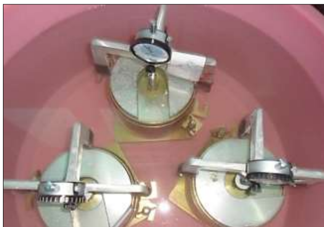
Figure VI.59 : Imbibition des essais de C.B.R.
