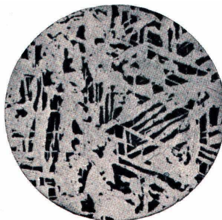
Fig.II.8.b- structure de weidmannstatten.
