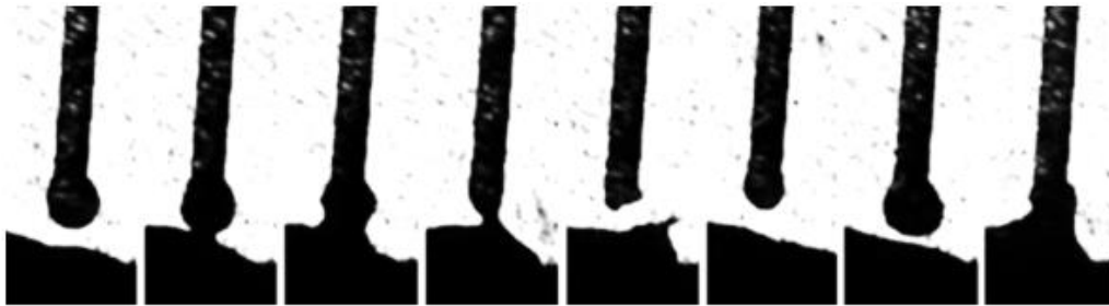
Figure. III.3: Transfert par court-circuit [2].
