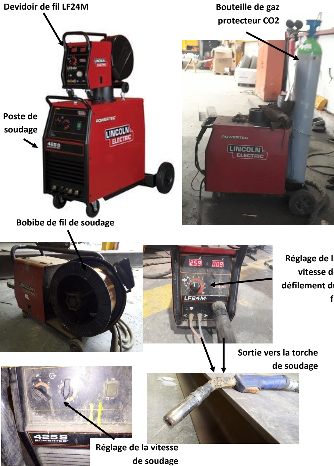
Figure IV-3 : matériel utilisé pour le soudage.
