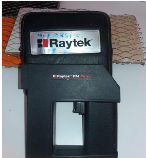
Figure IV. 11 Mesure de température à l'aide Thermomètre de type Raytek PM Plus Puis on répété le même travail avec les autre plaques de céramique.
