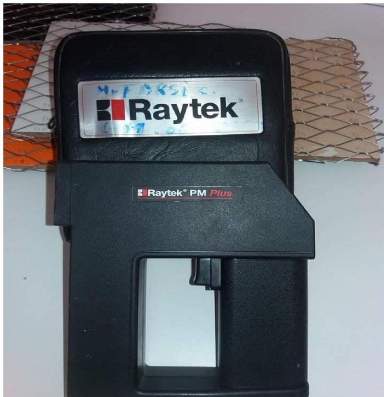
Figure IV.12 Mesure de température à l'aide d'un Thermomètre de type Raytek PM Plus.
