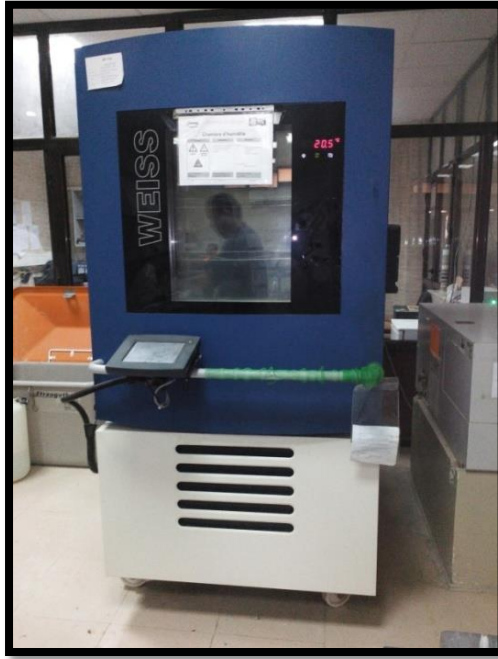
Figure IV-13 : La Chambre d'humidité.
