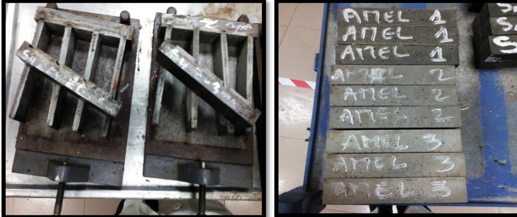
Figure IV-14: Démoulage des éprouvettes.
