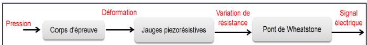
Figure I. 3: Schéma de principe d'un capteur de pression
