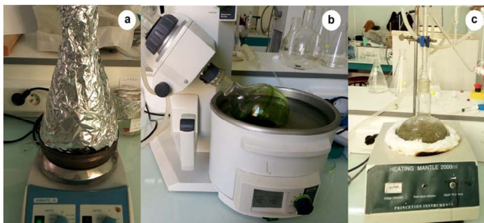
Figure 4- Procédés d'extraction : a) Macération, b) Evaporation sous vide, c) Hydrodistillation.
