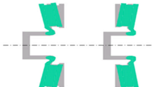
Fig. II.13 : Mise en cône d'un disque de frein. [13]
