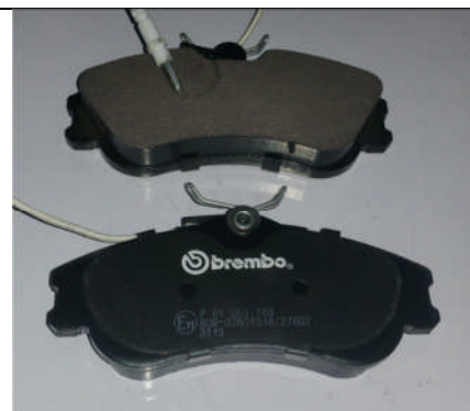
Fig. III.9 : Plaquettes de frein pour Peugeot 306 2.0HDI cette figure a été prise par les auteurs de ce momoire .
