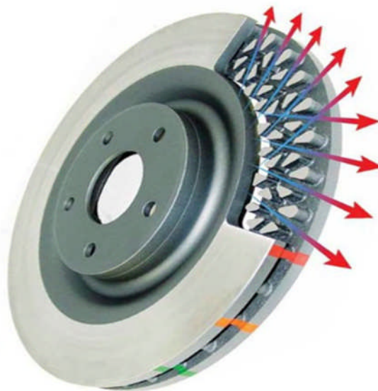
Fig. I.14 : Circulation de l'air dans les canaux d'un disque ventilé [16]
