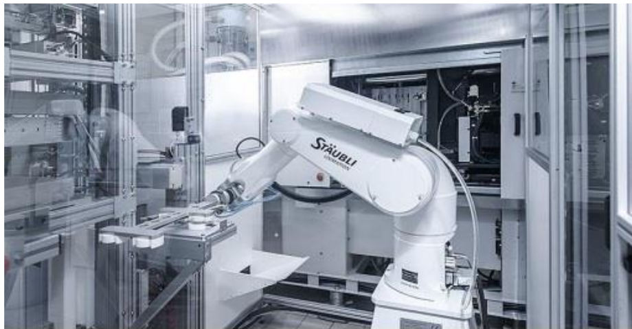
Fig 1.3 Robot manipulateur dans un environnement pharmaceutique sensible
