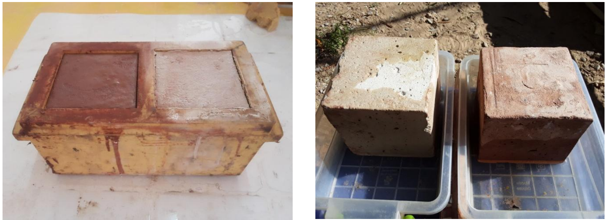
Figure VI.6 : Le nouveau matériau du coulage à l'tape d' absorption d'eaux.
