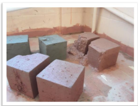
Figure VI.1 : Echantillons démolis par les fuites d'eau de pluie.
