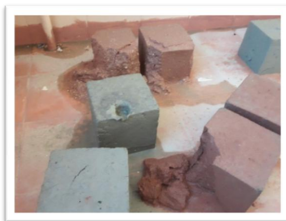
Figure VI.1 : Echantillons démolis par les fuites d'eau de pluie.
