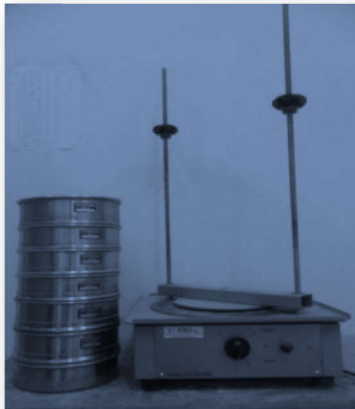
Fig.53 Appareillage d'analyse granulométrique.
