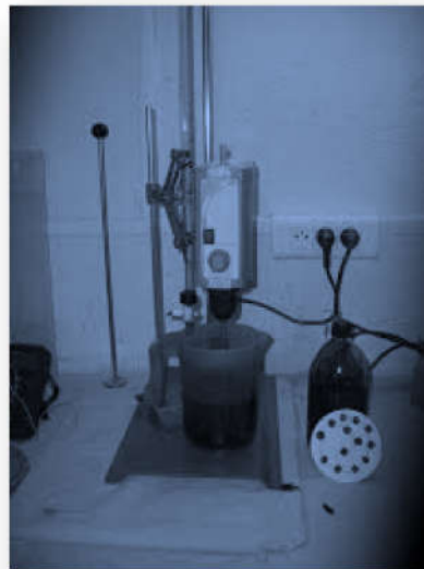
Fig.60 Appareillage de l'essai (bleu de méthylène).
