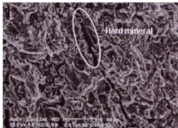
Fig.14 Ouverture des fissures en proximité des matériaux rigides Montes et al, (wakim j, 2005) [19].
