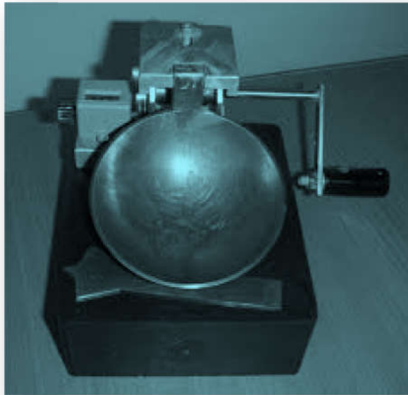
Fig.57 Appareil de Casagrande.
