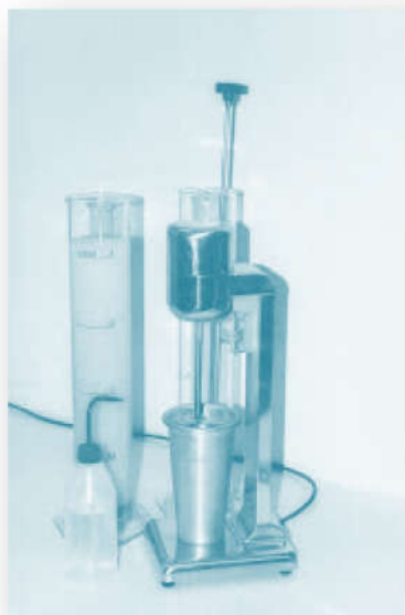
Fig.55 Appareillage d'analyse granulométrique ( sédimentométrie ).
