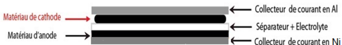
Figure III.11: Schéma d'assemblage du générateur électrochimique au lithium (^-)\text{Li} / \text{LiPF}_6 / \text{FePO}_4 (^+) .
