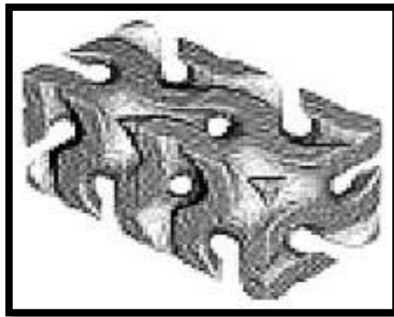
Figure I.7: Structure de silice mésoporeuse de type KIT-6.
